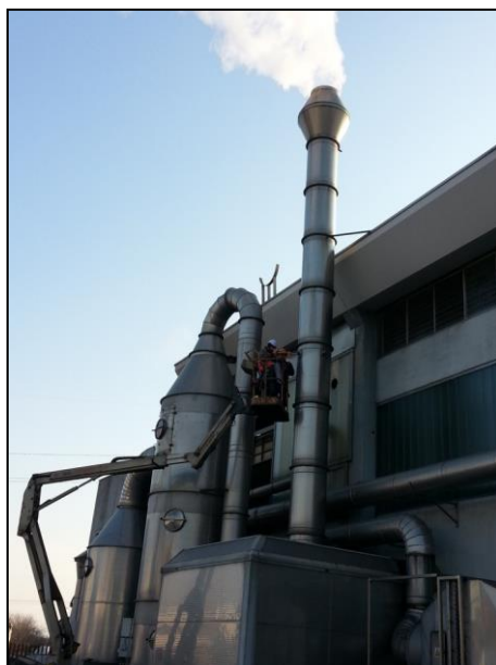
Figura 4: Fotografia delle operazioni di campionamento: camino 1/2A/2B/2C dell'impianto ILSA S.p.A
