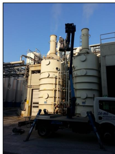
Figura 4: Fotografia delle operazioni di campionamento: a sinistra camino CM17 e a destra camino CM12 dell'impianto SICIT 200 S.p.A.
