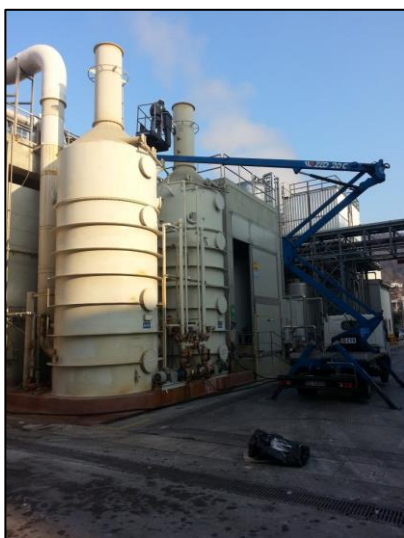
Figura 4: Fotografia delle operazioni di campionamento: a sinistra camino CM17 e a destra camino CM12 dell'impianto SICIT 200 S.p.A.
